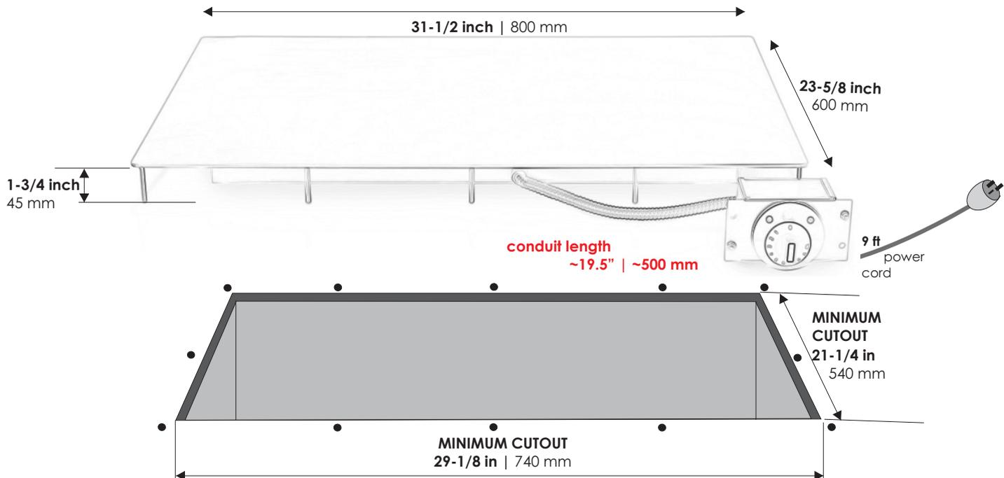
▶▶ Kontroll-Element MUSS FIXIERT SEIN. Alle Kabel müssen sicher verstaut und befestigt sein, nicht baumeln.
